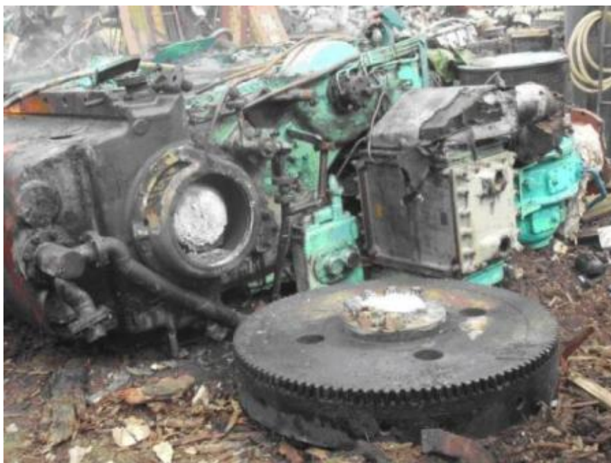
主機引擎曲軸切斷後
