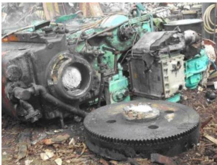
主機引擎曲軸切斷後
