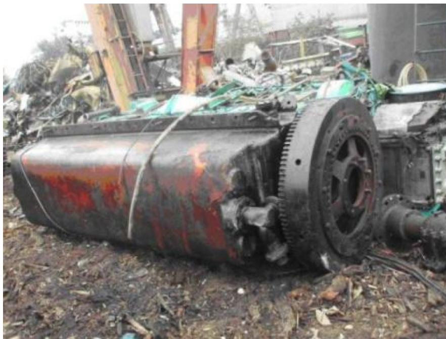
主機引擎曲軸切斷前
