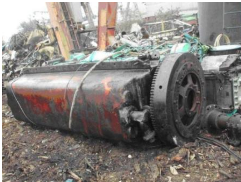
主機引擎曲軸切斷後
