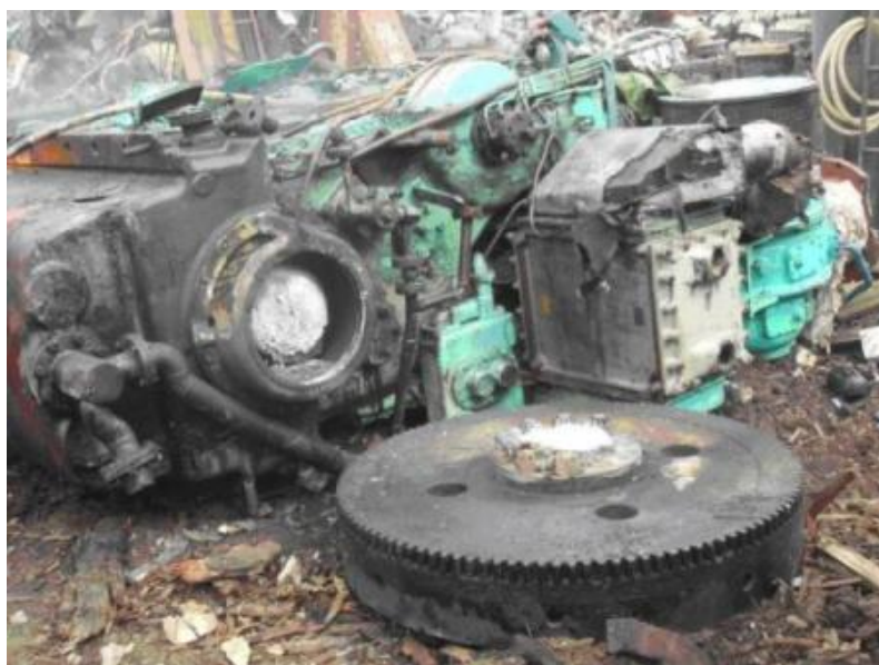
主機引擎曲軸切斷後
