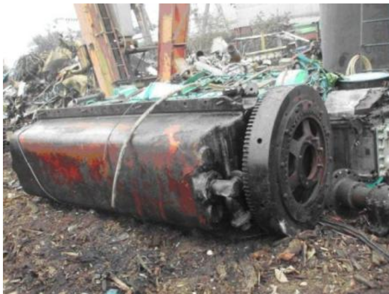
主機引擎曲軸切斷後
