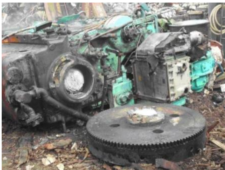
主機引擎曲軸切斷後
