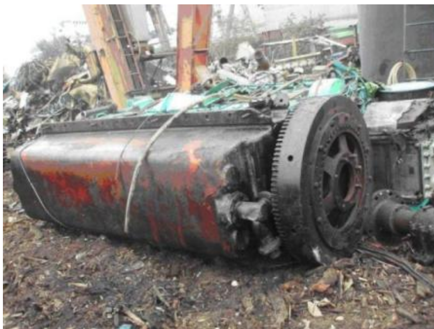
主機引擎曲軸切斷前
