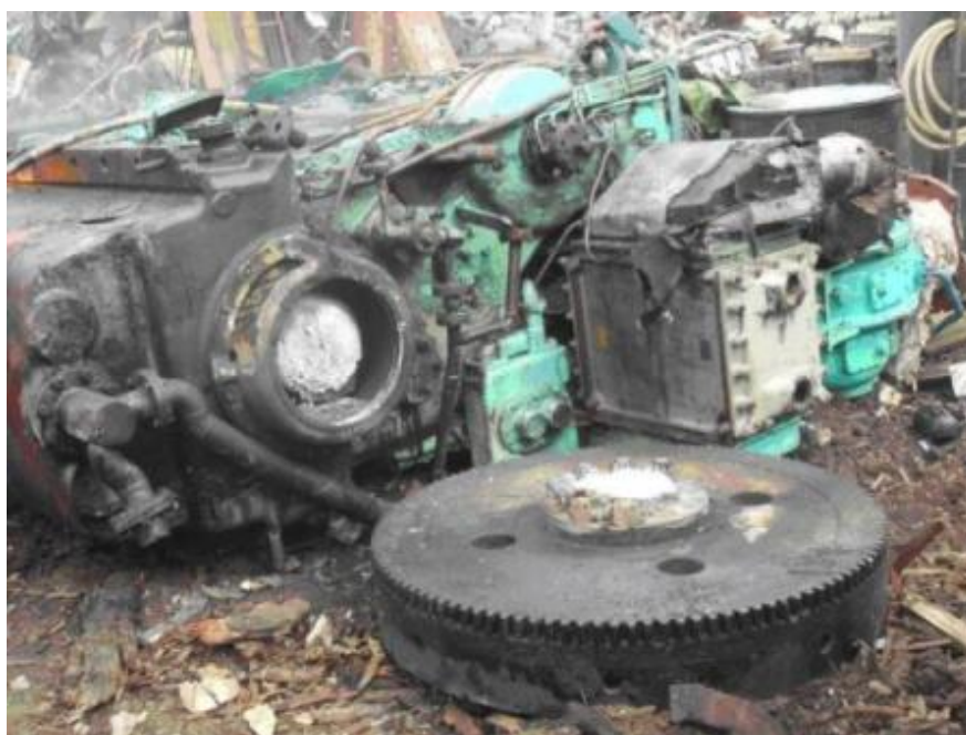
主機引擎曲軸切斷後
