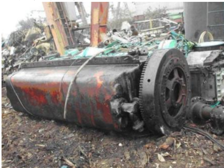
主機引擎曲軸切斷前
