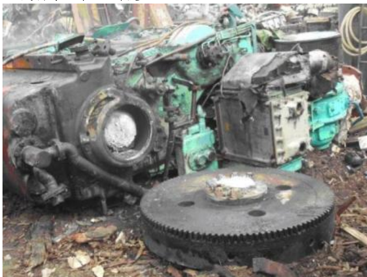
主機引擎曲軸切斷後
