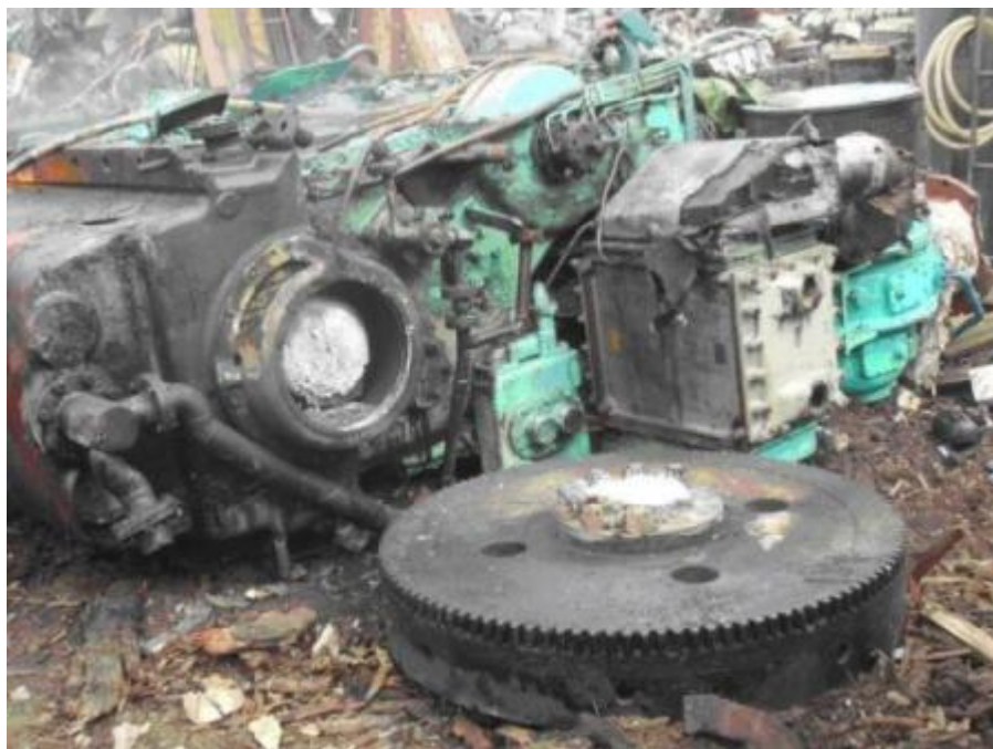
主機引擎曲軸切斷後
