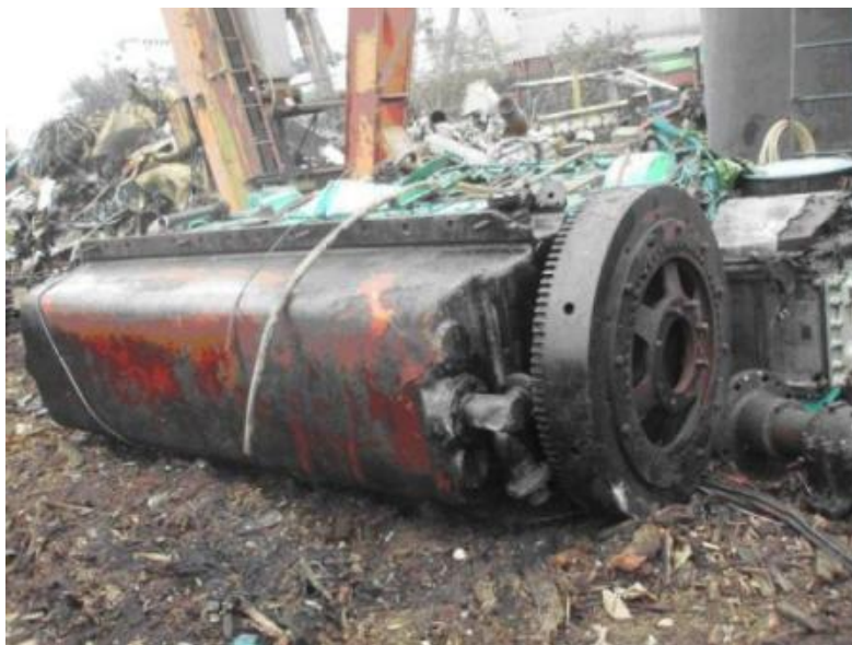
主機引擎曲軸切斷後
